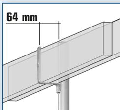
Montage avec planches ép 30 mm x ht 150 mm
