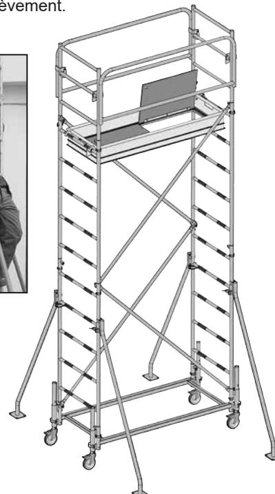
4 - Depuis l'intérieur du plancher mettre en place les échelles d'extrémité ainsi que les garde-corps longitudinaux, crocheter les cavaliers sur les barreaux de l'échelle d'extrémité, mettre les **goupilles 8x40** sur les échelles.
