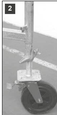
La vis papillon doit entrer légèrement dans le trous de fixation du rétreint afin d'assurer correctement le verrouillage et l'anti-déboîtement du pied (photos 2).
