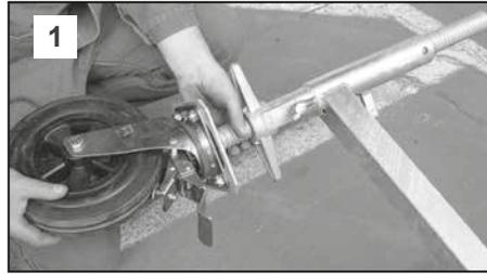
Pour les versions EVOLIS 300, verrouiller les 4 roues à l'aide des vis papillon fixées sur les manettes de réglage des vé-rins (photos 2).
