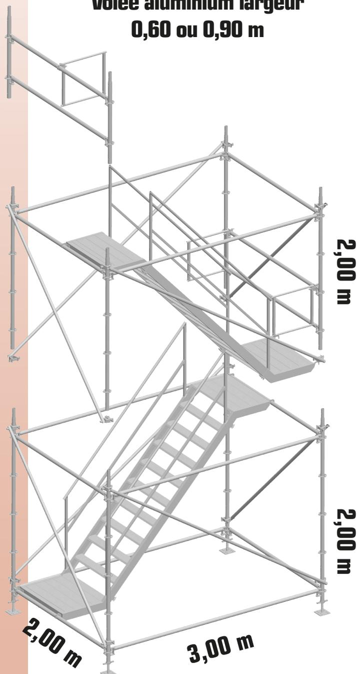
Configuration réalisée avec une volée de 0,90 m
