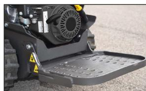
Plateforme équipée de 2 butées à ressort pour éliminer les vibrations et les chocs
